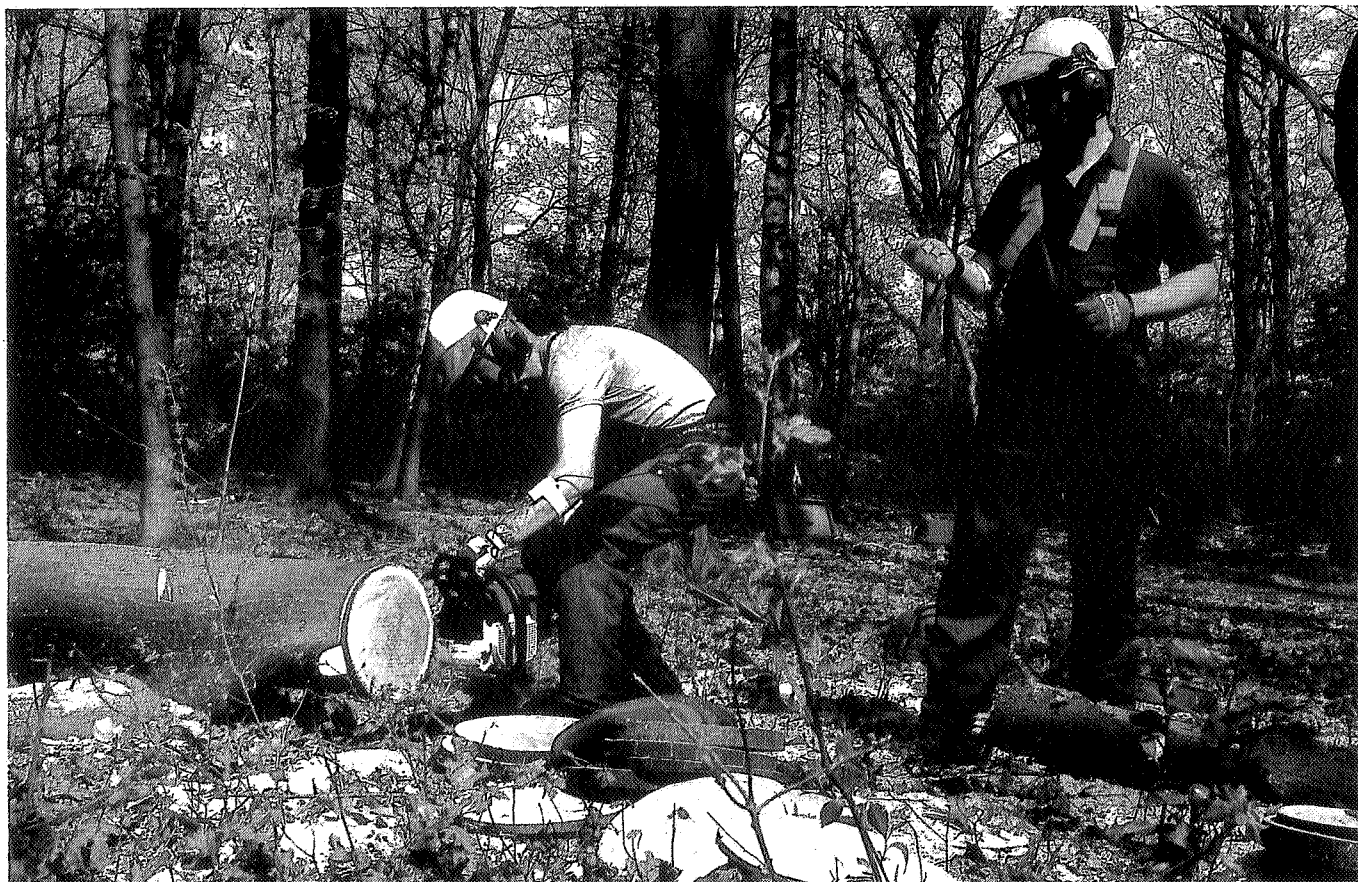
De keuze van de motorkettingzaag heeft een grote invloed op de blootstelling en daarmee op de maximale dagelijkse werktijd. Een zo licht mogelijke zaag beperkt de blootstelling, maar met geen van de geteste zagen kun je zonder maatregelen een hele dag werken.
